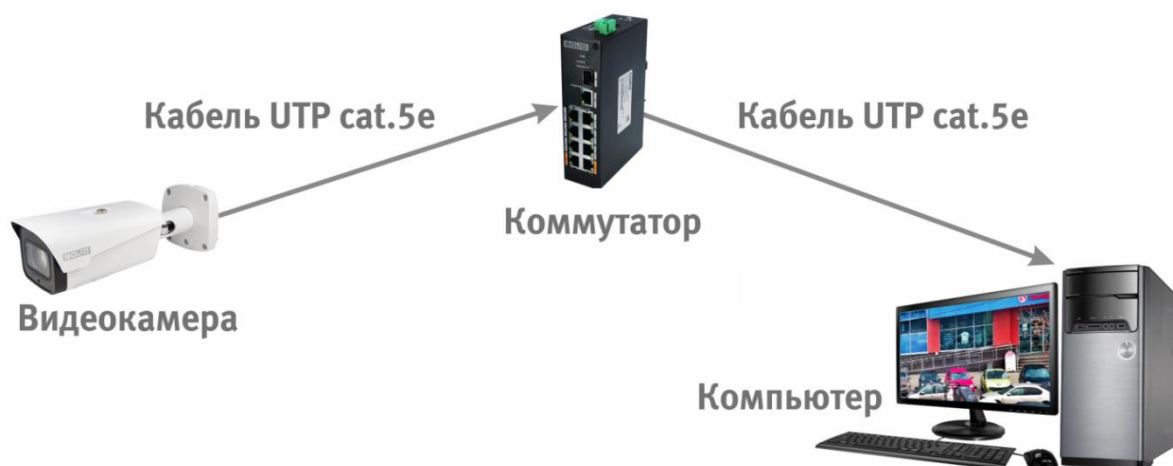
Рисунок 6.4 – Схема подключения видеокамеры к компьютеру через коммутатор
