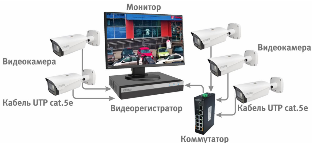
Рисунок 6.5 – Схема подключения видеокамеры к видеорегистратору
