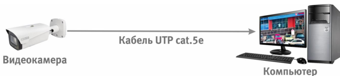
Рисунок 6.3 – Схема подключения видеокамеры к компьютеру
